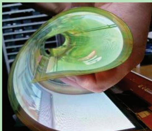
Южнокорейская компания LG продемонстрировала 18-дюймовую OLED-панель, которая может сгибаться и сворачиваться в трубку диаметром 3 сантиметра. При этом даже в скрученном состоянии монитор, построенный на базе этой панели, будет продолжать работать.
